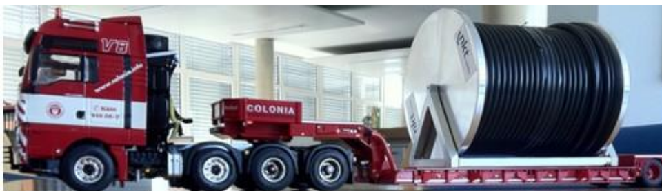
Abbildung 101: Spule mit 1200 m Höchstspannungskabel im Hochspannungsprüffeld unten: „gedrehte“ Spule für extreme Transportlängen (Modell; Quelle: nkt cables)
