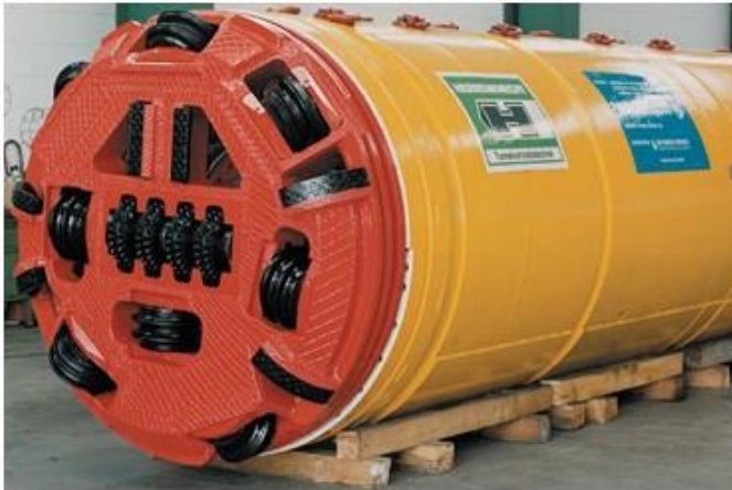
Abbildung 75: Slurryschild mit Felsbohrkopf vom Typ AVN 1500 T (Außendurchmesser 1980 mm) [45]
