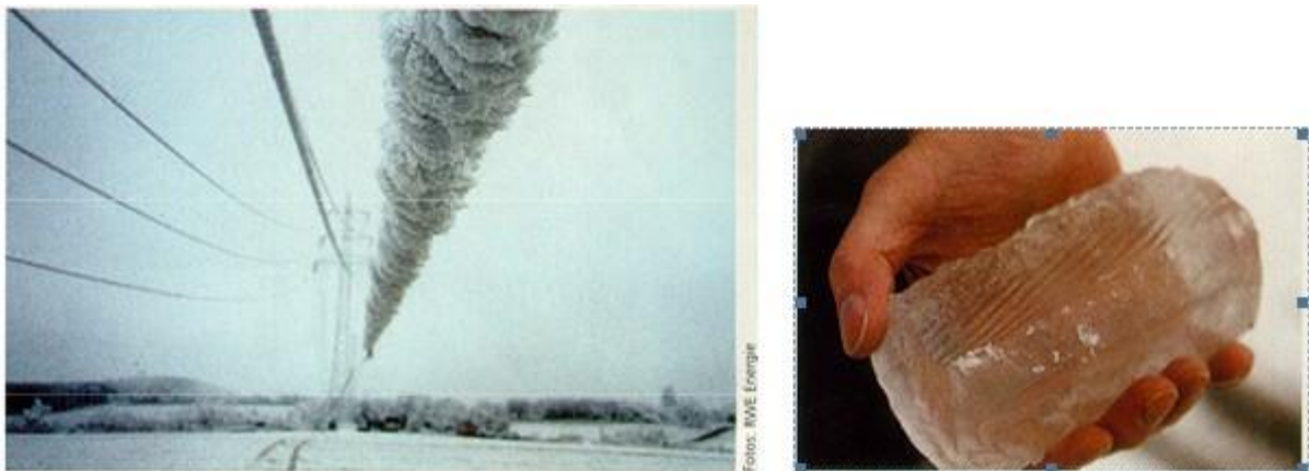
Abbildung 103: links: Eisbehang eines abgerissenen Freileitungsseiles; rechts: Eisklumpen mit Seilabdruck (Quelle: RWE AG)
