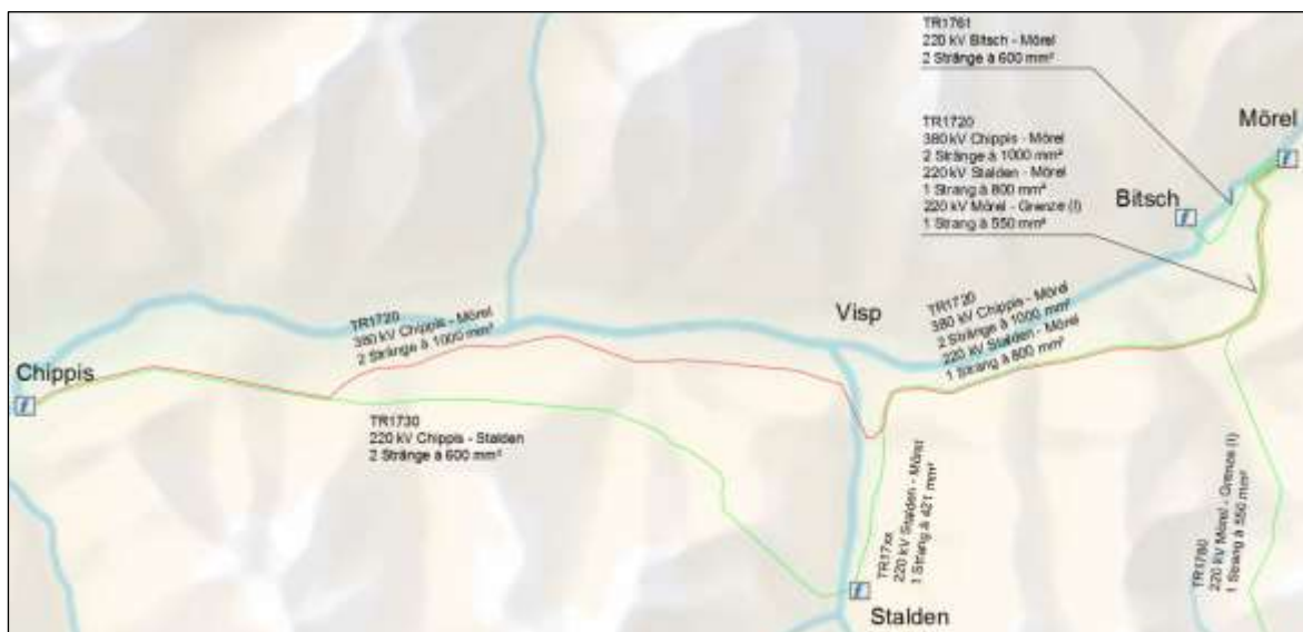
Abb. 3: Geplanter Ausbau Chippis – Mörel-Filet
